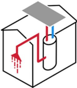
L'energia termica viene trasferita dalla luce solare all'acqua attraverso un pannello situato sul tetto della casa, in cui circola un fluido che, attraverso una pompa ed una centralina elettronica, trasferisce l'energia al serbatoio che si trova in un locale della casa.
